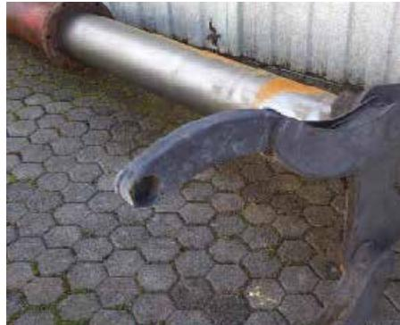
Ausgebauter alter Kolben mit Aufnahme
